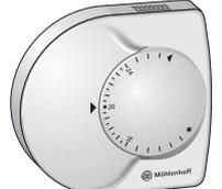
Переключ. мощность: макс. 5 приводов<br>Диапазон температур: от 10 °С до 28 °С<br>Рабочее напряжение: 230 В 50 / 60 Гц<br>Ток включения (макс.): 0,2 А (омич. нагрузка)<br>Размеры (мм) В / Ш / Г: 80 / 84 / 27 |      |     |      |     |
