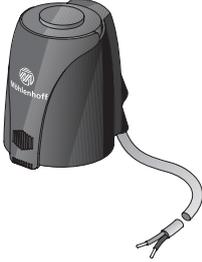
Рабочее напряжение: 24 В<br>Класс защиты: III<br>Потребление мощности: 1,8 Вт<br>Степень защиты: IP 54 (во встав. соедин. проводом)<br>Рабочий ход: 4 мм<br>Усилие управления: 100 N ± 5 %<br>Соедин. провод (штепс.): 2 x 0,75 мм <sup>2</sup><br>Цвет кожуха: белый RAL 9003<br>Размеры (мм) В/Ш/Г: 55+5/44/6 |      |     |      |     |
