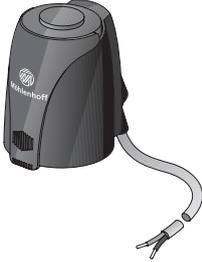
Рабочее напряжение: 230 В<br>Класс защиты: III<br>Потребление мощности: 1,8 Вт<br>Степень защиты: IP 54 (во встав. соедин. проводом)<br>Рабочий ход: 4 мм<br>Усилие управления: 100 N ± 5 %<br>Соедин. провод (штепс.): 2 x 0,75 мм <sup>2</sup><br>Цвет кожуха: белый RAL 9003<br>Размеры (мм) В/Ш/Г: 55+5/44/6 |      |     |      |  |
