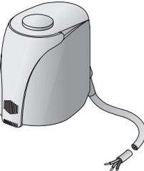
Рабочее напряжение:<br>24 В – 10 % до +20 %, 50 / 60 Гц<br>Входное сопротивление: 100 кОм<br>Соединительная линия (вставная) 3 x 0,22 мм <sup>2</sup><br>Среднее время срабатывания: 30 с / мм<br>Длина линии: 1000 мм<br>Цвет корпуса: серо-белый<br>Размеры (мм) В / Ш / Г: 60,5 + 4 / 44 / 64 |      |     |      |     |
