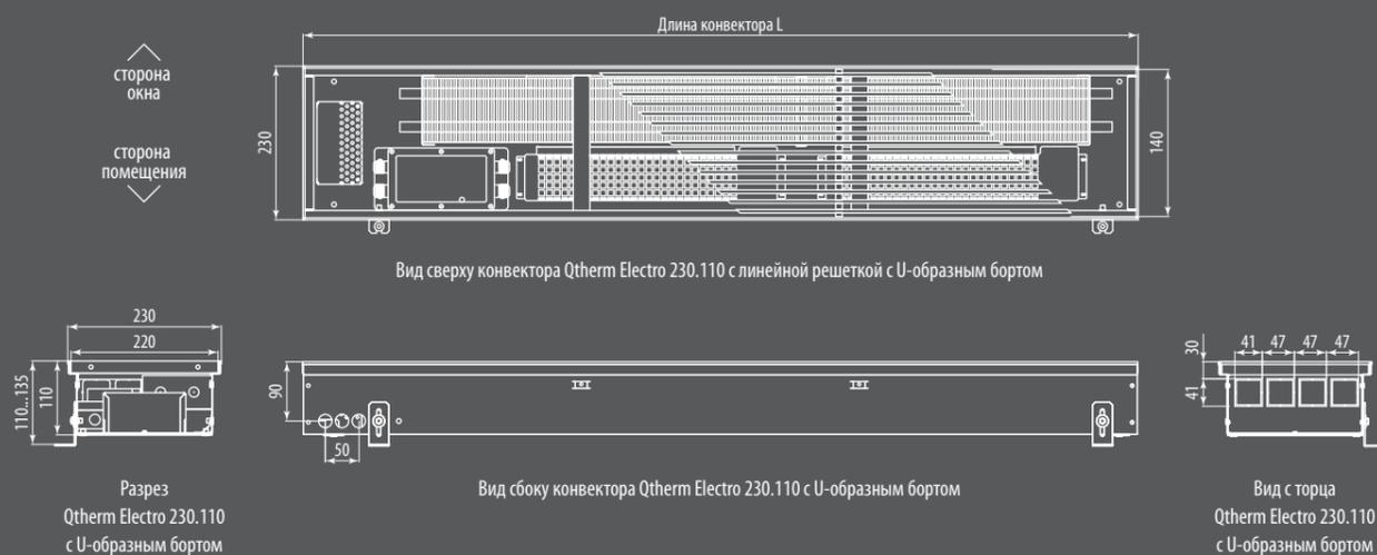
Вид сверху конвектора Qtherm Electro 230.110 с линейной решеткой с U-образным бортом
