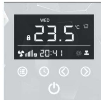
Регулирование температуры в помещении при микропроцессорной схеме регулирования осуществляется программируемыми регуляторами типа 703201 (черного цвета) или 703202 (белого цвета) через сенсорный экран путем плавного изменения скорости вращения вентиляторов и управлением термоэлектрическим сервоприводом линии нагрева. Конвектор можно подключать к любым инженерным системам, в том числе «умный дом» по протоколу ModBus через RS485.
