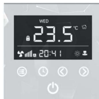
Регулирование температуры в помещении при микропроцессорной схеме регулирования осуществляется программируемыми регуляторами типа 703201 (черного цвета) или 703202 (белого цвета) через сенсорный экран путем плавного изменения скорости вращения вентиляторов и управлением термoeлектрическим сервоприводом линии нагрева. Конвектор можно подключать к любым инженерным системам, в том числе «умный дом» по протоколу ModBus через RS485.
