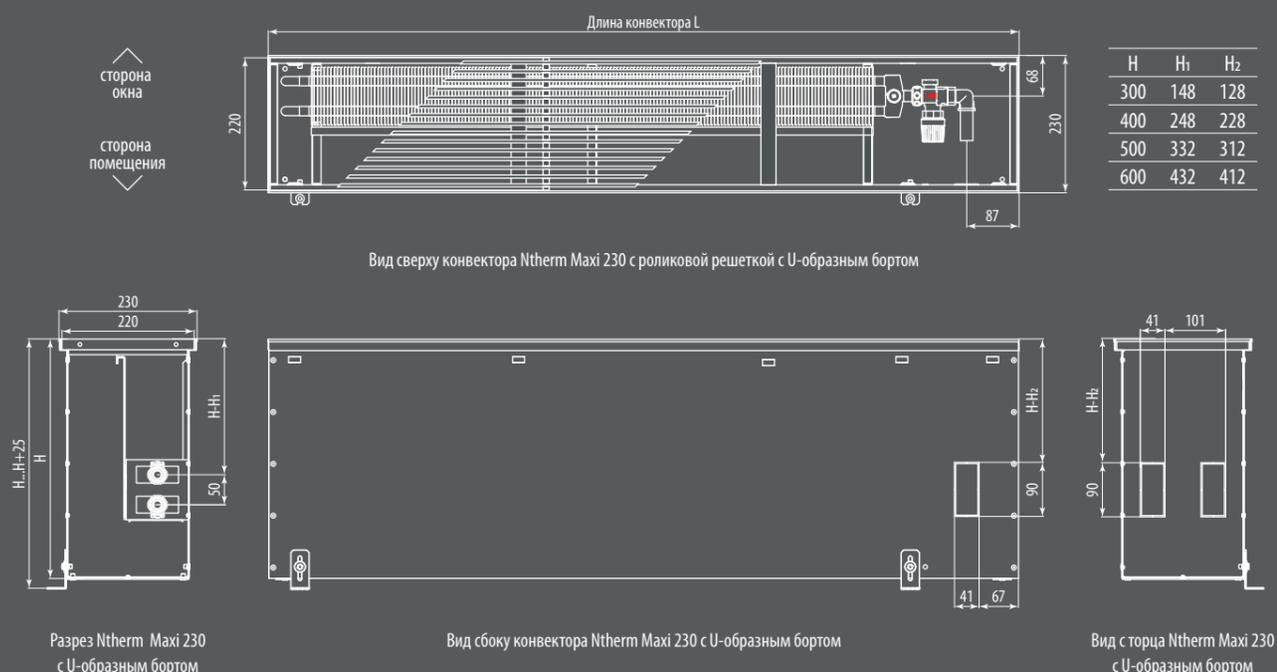
Вид сверху конвектора Ntherm Maxi 230 с роликовой решеткой с U-образным бортом
