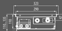
Разрез Qtherm 300.110 с F-образным бортом
