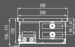
Разрез Qtherm 300.150 с U-образным бортом
