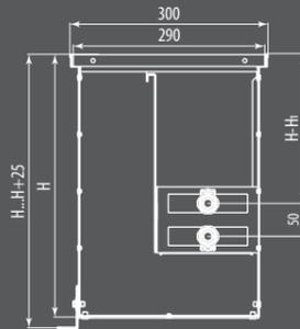
Разрез Ntherm Maxi 300 с U-образным бортом
