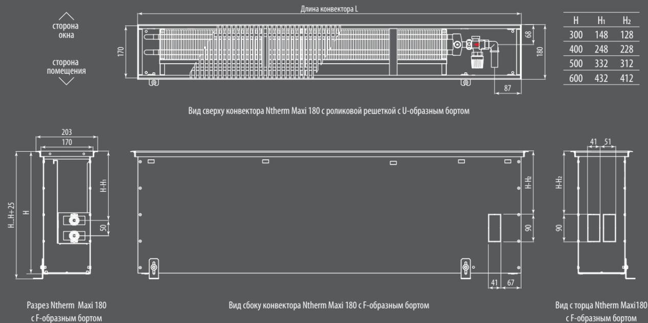
Теплопроизводительность Ntherm Maxi 180 [Вт]
