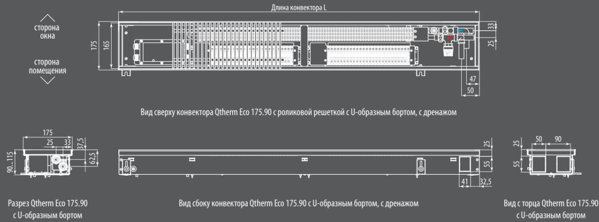
Вид сверху конвектора Qtherm Eco 175.90 с роликовой решеткой с U-образным бортом, с дренажом
