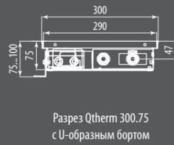
Разрез Qtherm 300.75 с U-образным бортом
