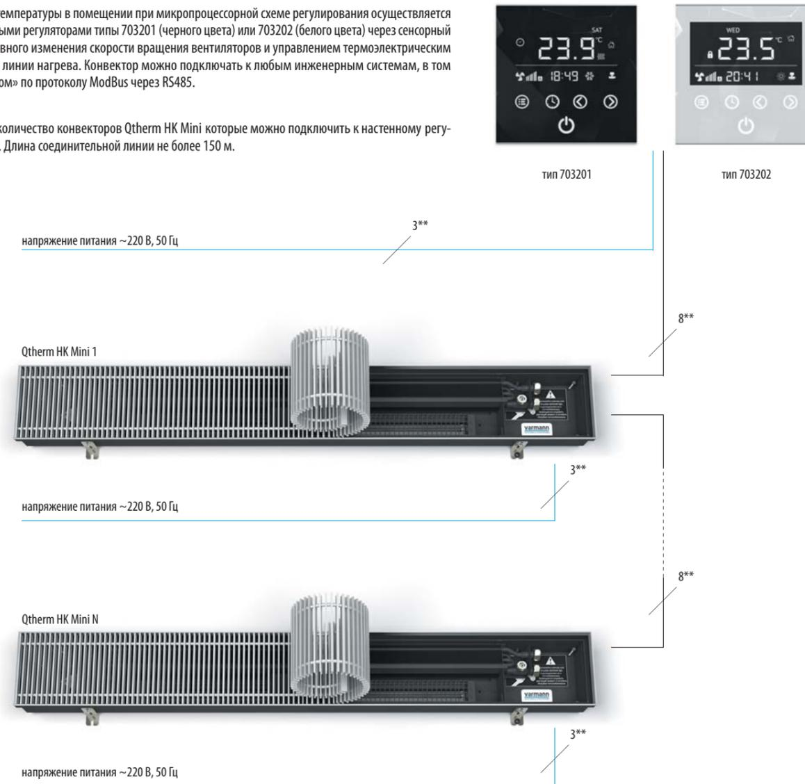
\* Для соединительных линий применяется восьмижильный, экранированный кабель UTP 4x2x0,4.
