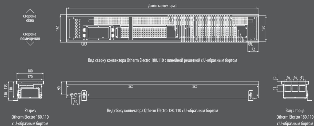
Вид сверху конвектора Qtherm Electro 180.110 с линейной решеткой с U-образным бортом
