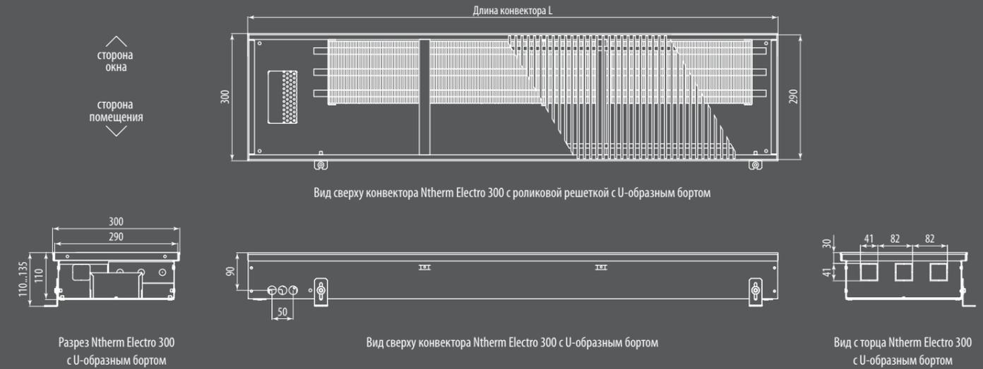
Разрез Ntherm Electro 300 с U-образным бортом
